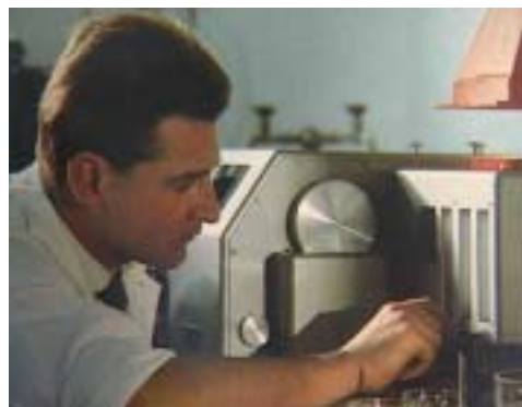
Basis i det nye ZEISS fotometer var en helt ny monokromator, der kunne spalte lyset i ekstremt smalle spektre. MQII monokromatoren er den dag i dag ikke overhalet på specifikationerne af et moderne instrument.
